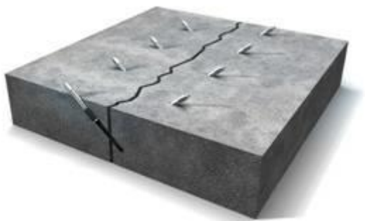
Рис. 6. Схема расположения пакеров
